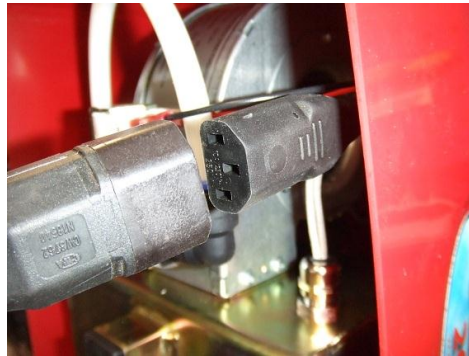
3. Tag fram den medföljande kompressorn. 4. Sätt ihop kompressorns kabel med brännarens kabel. Se bild.
