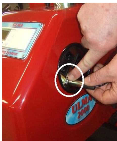
2. Tryck in spärren innan du drar ut tempgivarkontakten.
