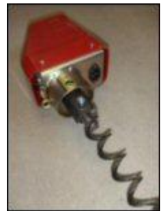
11. Spiralen monterad på motorn.
