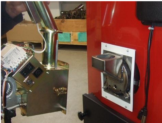
7. Lyft av bakre delen av brännaren.
